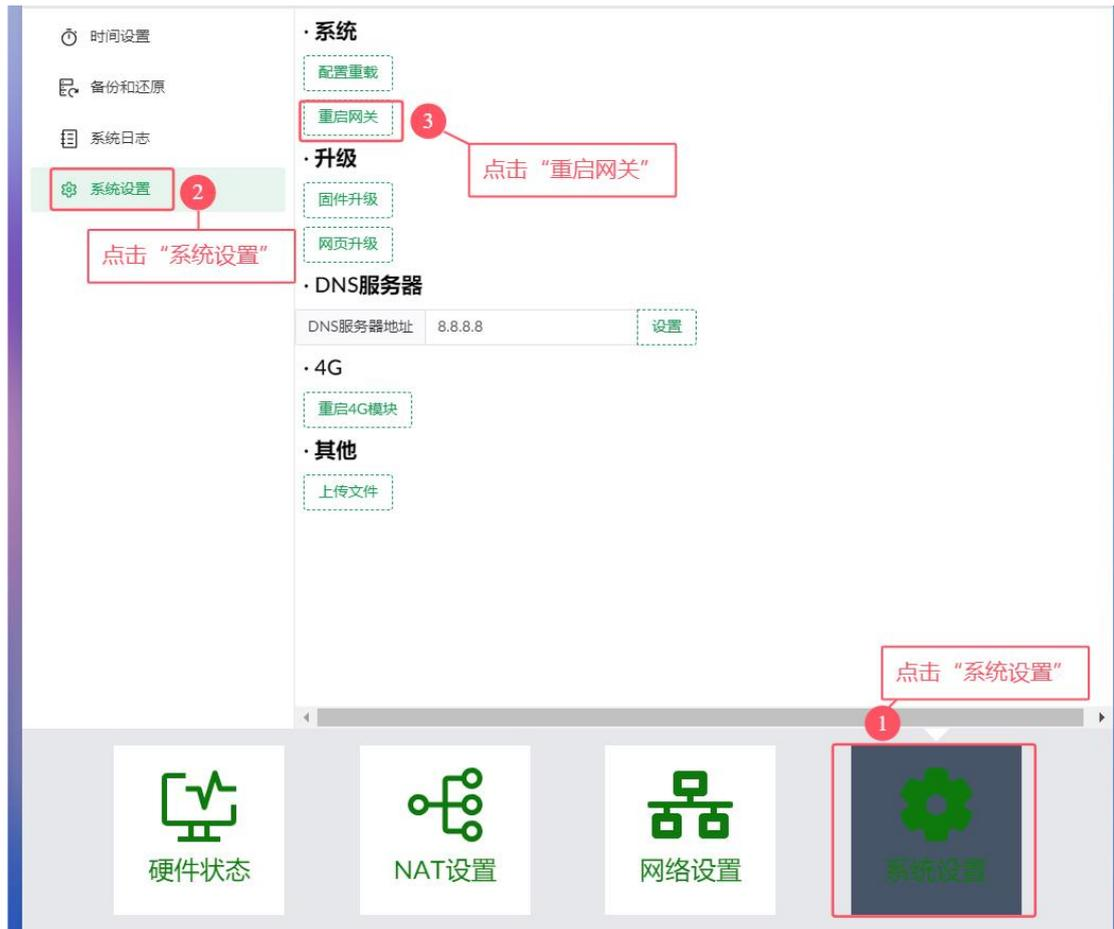
网关正常重启时，界面会提醒“正在重启，请稍后”，时间大概在 25 秒左右，请耐心等待其自动重启，自动重启好以后会自动进入配置界面。
