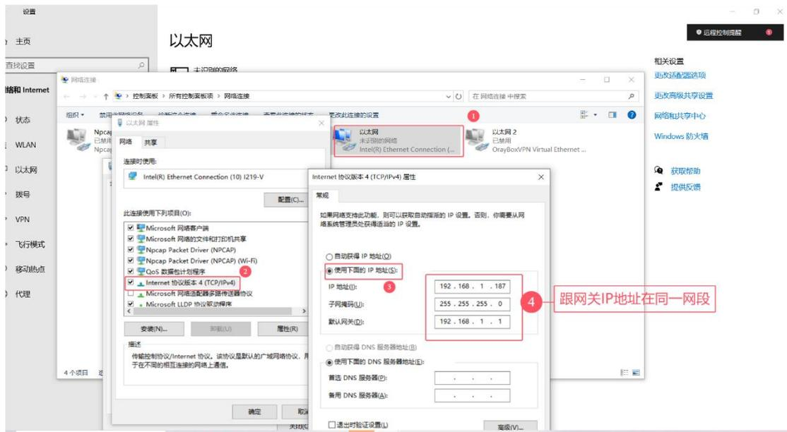
笔记本网线接入到 LAN1 网口，在浏览器（推荐使用谷歌浏览器）输入 192.168.1.230 地址后，会进入网关配置界面。
